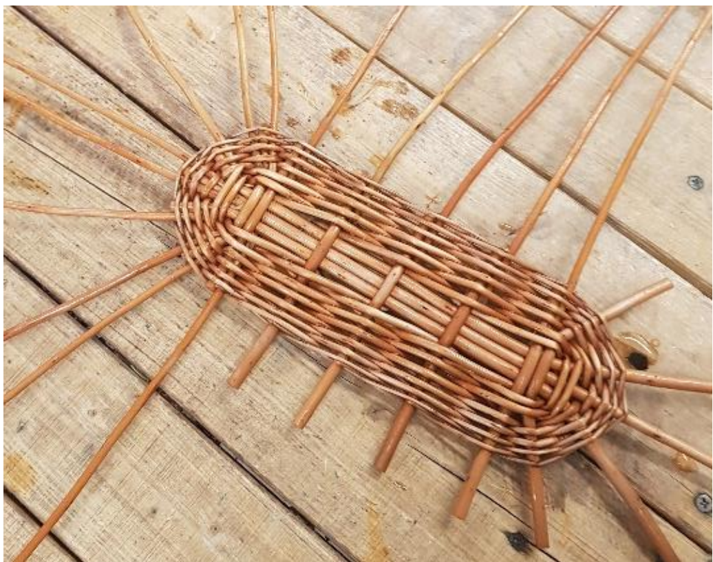
Fot. 4. Umocowanie w dnie konstrukcji bocznej koszyka (osnów, spałek)
