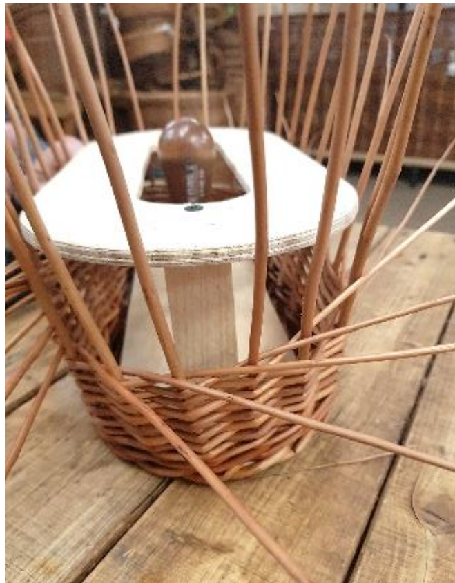
Fot. 8. Wykonanie ściany bocznej – splot skośny
